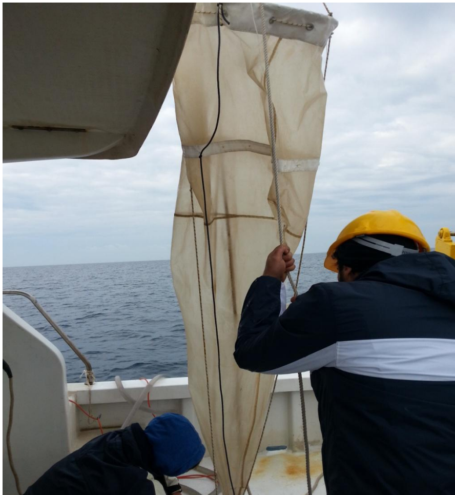
Figura 6: Retino utilizzato per il campionamento dello zooplancton
