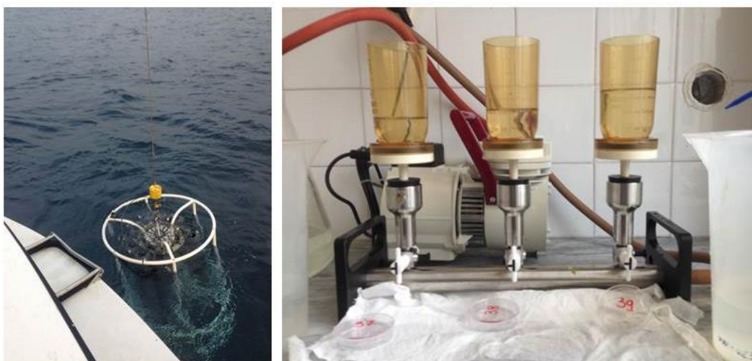
Figura 7: Dettaglio di un prelievo superficiale di acqua tramite Niskin, montate in serie su una rosetta (sinistra) e fase di filtrazione del campione a terra (destra)
