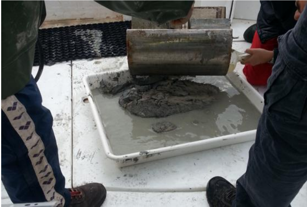
Figura 100: Dettaglio di un campione raccolto con la benna
