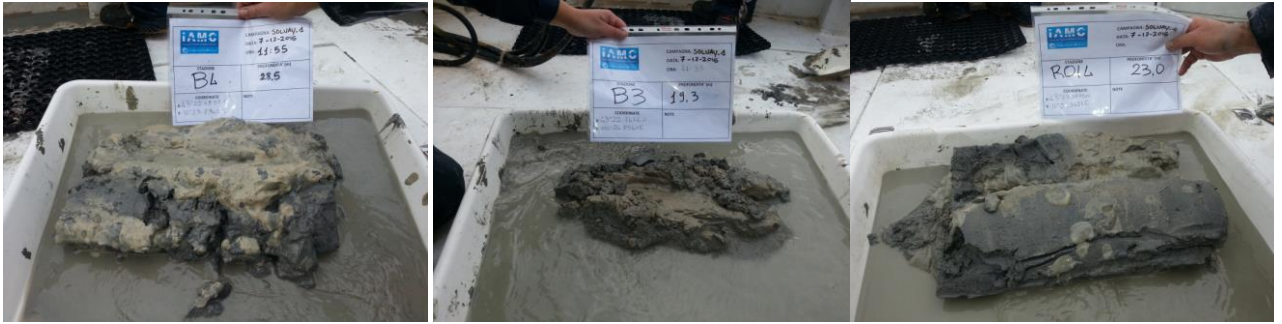
Figura 172: Campioni di sedimento superficiale prelevati con l'ausilio di una benna
